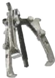
**Extractores de tipo mordaza:** tanto manual como hidráulico. Para conseguir una mayor fuerza y comodidad, utilice un extractor hidráulico. Ambos están disponibles en configuraciones de 2 o 3 mordazas y se utilizan para sujetar la circunferencia exterior de una pieza, o bien, pueden usarse con un accesorio de extracción, como un adaptador para cojinetes o poleas (páginas 196-197, 210-213, 222-223)
