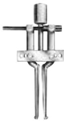
**Los accesorios de extracción internos** poseen mordazas estrechas que se introducen por el centro de la pieza que se desea extraer. Proporcionan una extracción en línea recta y evitan causar daños en los alojamientos. Los accesorios internos poseen mordazas ajustables para adaptarlas a los distintos diámetros de las piezas (página 200)
