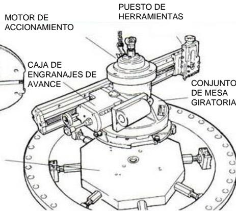
La refrentadora *Mactech MTF1445* se fabrica, como el resto de la gama, a partir de materiales de la más alta calidad. Esta diseñada para dar precisión de taller de mecanización, combinada con facilidad de manejo y portabilidad, en el intervalo de bridas de 355 mm (14") a 1.140 mm (45"). La máquina consta de cuatro conjuntos principales:
