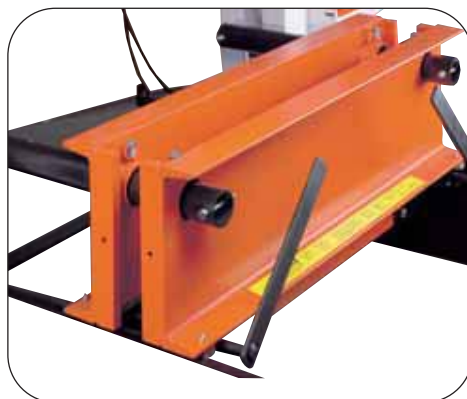
La anchura se ajusta desde 102 mm a más de 686 mm; se sujeta con pernos de fijación.
