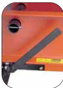
La palanca baja la placa de asiento para prensar y la sube para rodar.
