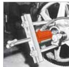
El impulsor-extractor Push-Puller® de accionamiento hidráulico retira la rueda de tracción. El accesorio de tracción se utiliza para proporcionar una superficie de agarre.
