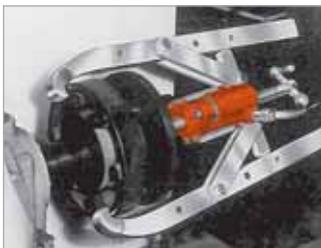
Desmontaje de un acoplamiento flexible del eje de un motor eléctrico con el extractor de 2 mordazas.
