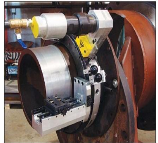
Torno Clamshell 814LC con accesorio de avance axial
